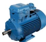
Взрывозащищенные электродвигатели серии предназначены для эксплуатации во взрывоопасных зонах помещений и наружных установок, в которых могут образовываться взрывоопасные смеси горючих газов или паров с воздухом, относящихся к категориям IIА, IIВ, и группам самовоспламенения Т1, Т2, Т3 и Т4.
